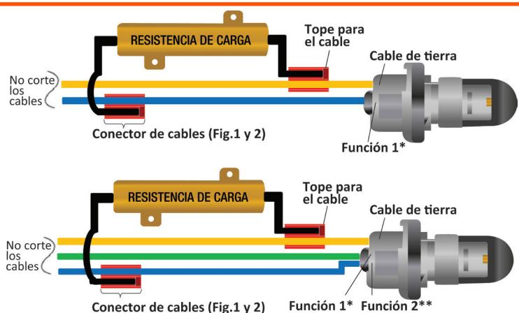
\*Función 1 - Cable que no requiere una resistencia de carga, como luces de cuartos
