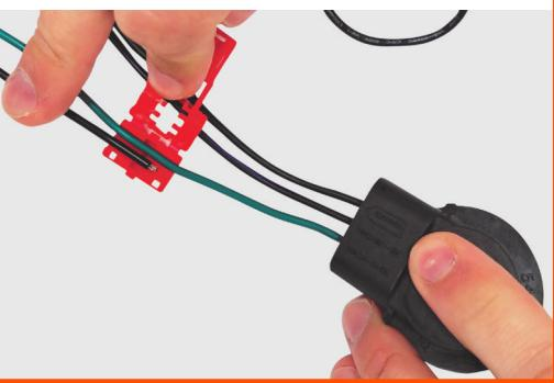
4 Refermer la dernière partie du connecteur. Cette partie comprend une plaque en métal qui est forcée dans le connecteur et qui coupe la gaine des fils, reliant électriquement les deux fils. À l'aide d'une pince, s'assurer que le connecteur est bien refermé. Les fils devraient être solidement fixés dans le connecteur.
