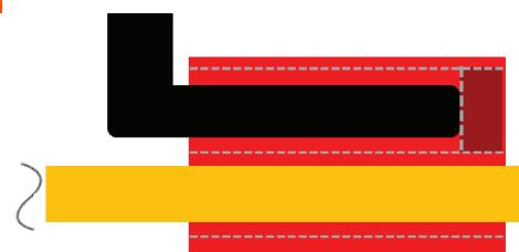
3 Sujete la herramienta perpendicularmente al cable y haga la conexión presionando la terminal en forma de U hasta estar al ras de la superficie plástica del conector.
